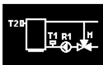
Schéma s 3-cestným ventilem od zdroje vytápění.
