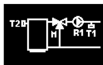
Schéma s 3-cestným ventilem na zpátečce.
