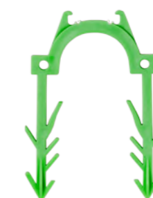
W983-1 tacker spona min. tloušťka izolace 35 mm výška sponky 50 mm
