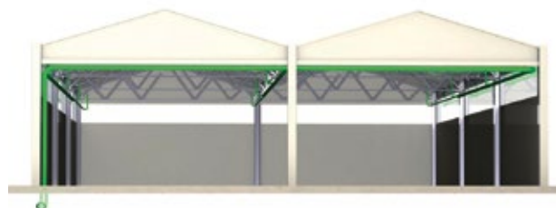
Podtlakový systém odvodnění
