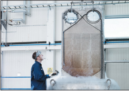
▲ Obr. 7 ● S pomocí látek, jako jsou tekutý dusík a hydroxid sodný, jsou původní těsnění a lepidla odstraňována šetrně, úplně a drážky na deskách zůstávají nedotčeny
