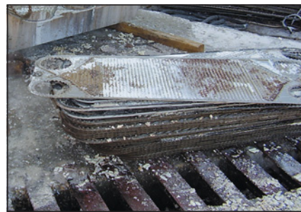
▲ Obr. 6 ● I takto může vypadat čištění desek výměníku prováděné nekvalifikovanou firmou
