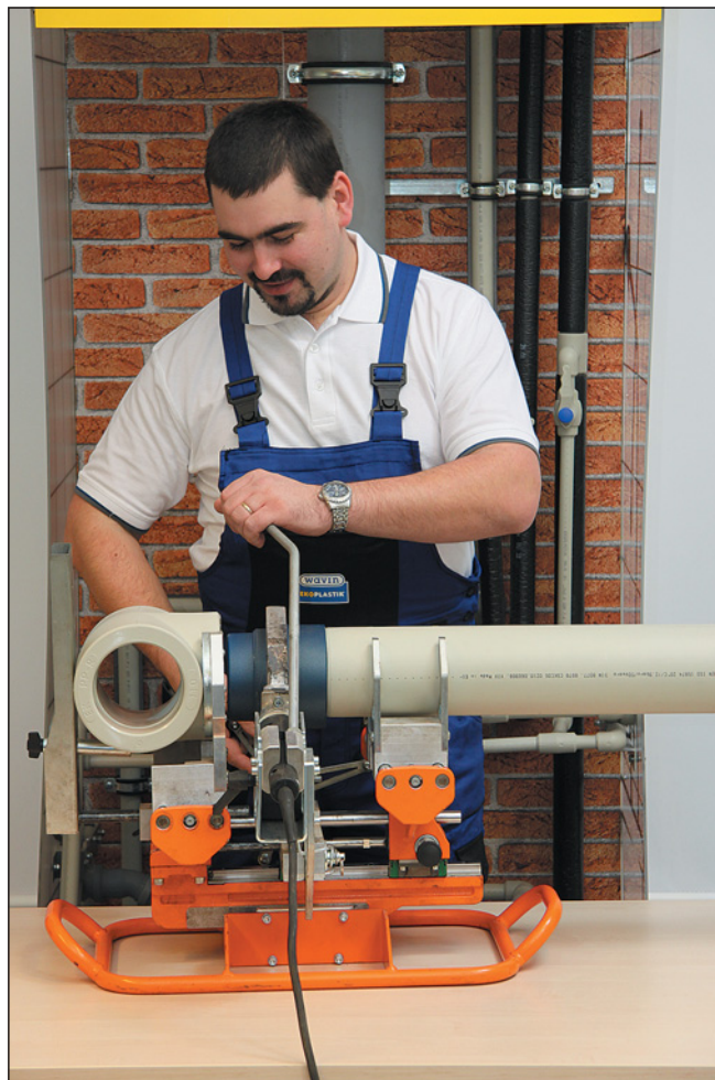
▲ Obr. ● Spojování plastových trubek a tvarovek z PPR a PP-RCT se provádí metodou polyfúzního svařování
