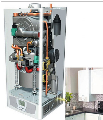
Obr. 3 Příklad kompaktní mikrokogenerační jednotky se Stirlingovým motorem, ve které je zdrojem tepla kondenzační kotel a příklad jejího umístění – zde je použit Stirlingův motor i generátor s přímým pohybem bez rotačních částí
