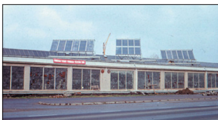
▲ Obr. 10 ● Druhá československá měřicí stanice slunečních kolektorů (Žiar nad Hronom – SR, 1988), z důvodu nemožnosti zajistit kvalitní automatické měření se opět porovnávala výsledná teplota podle referenčního typu kolektoru za účasti obsluhy
