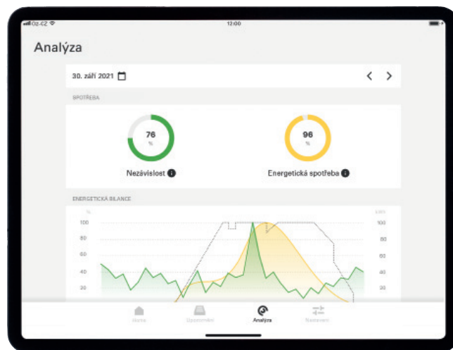
▲ Obr. 1 ● Analytický nástroj zobrazuje aktuální a předchozí míru soběstačnosti a vlastní spotřeby
