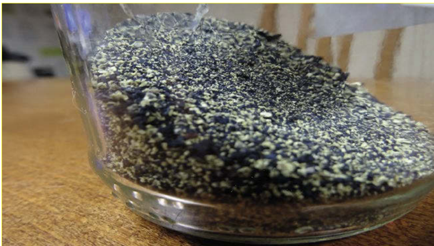
▲ Obr. 9 ● Korozní produkty a nánosy odebrané z otopné soustavy
