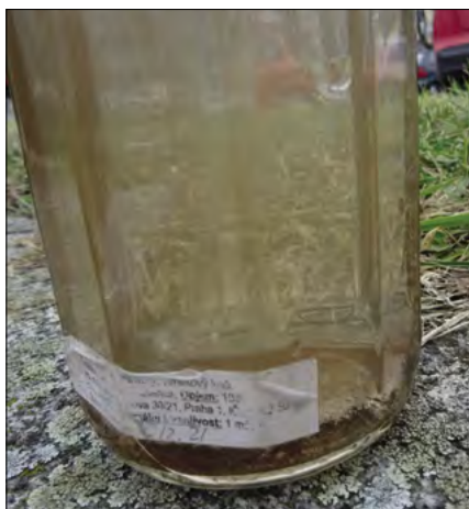
▲ Obr. 7 ● Teplonosná kapalina – zákaly i úsady jsou v obvyklém množství
