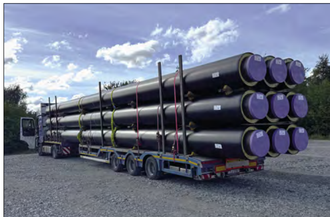
▲ Obr. 4 ● NRG flex se opírá o nejsilnější inovátory Evropy. Firma POLIURS aktuálně dodává do Švédska potrubí DN600/DA800 v délce až 18 m oproti standardním 12metrovým – to přináší výraznou úsporu času, financí a také zvyšuje technickou bezpečnost celého potrubního systému
