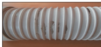
▲ Obr. 3 ● Prokousaná flexibilní napojovací trubka a detail prokousaných otvorů
