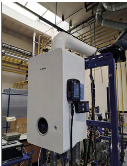
▲ Obr. 2 ● Měření APOKS ve strojírenském zkušebním ústavu ve spolupráci s BOSCH ČR – měření složení spalin při spalování 10% a 30% H 2 ve směsi se zemním plynem
