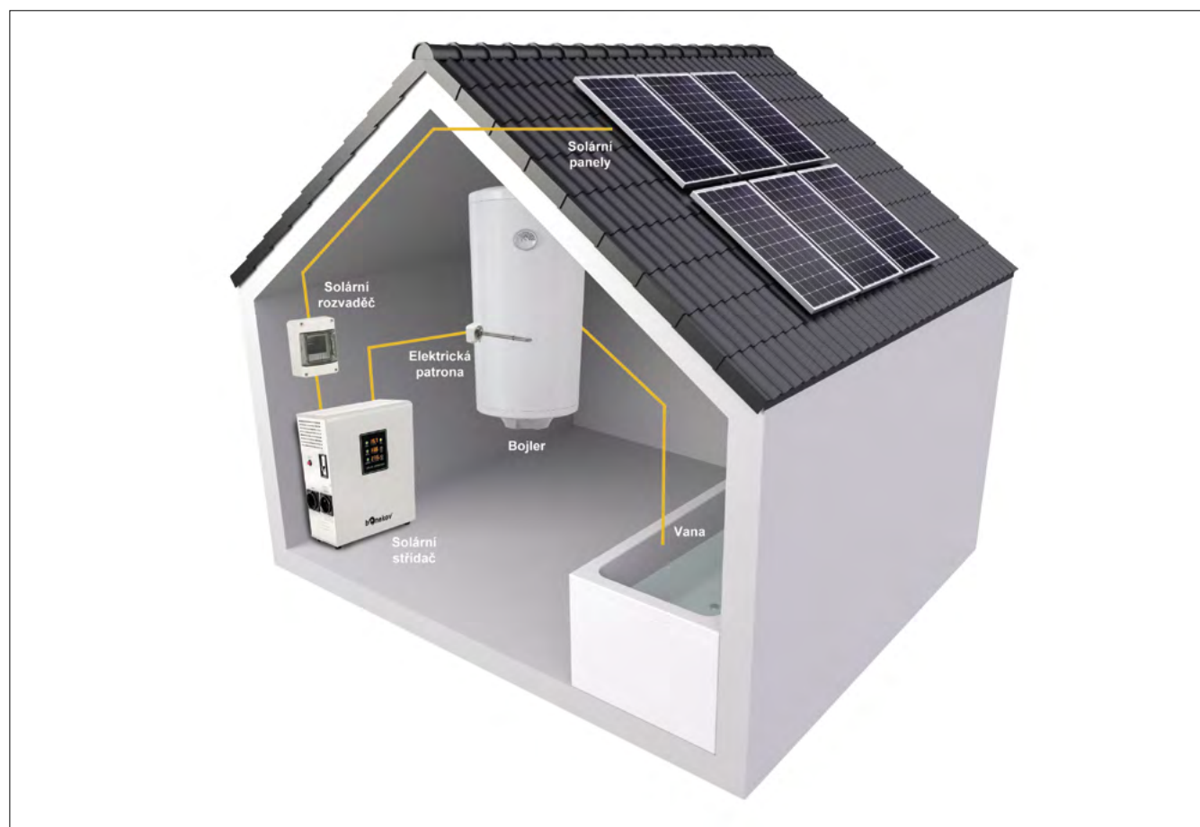
▼ Obr. 1 ● Schéma solární sestavy pro přípravu teplé vody
