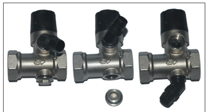
▲ demontáž zátky ▲ demontáž kolena ▲ montáž kolena
