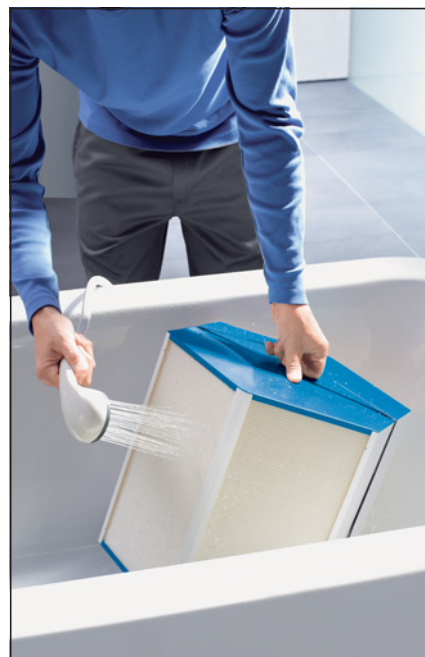
▲ Obr. 5 ● Inovativní konstrukce entalpických výměníků Zehnder a Paul s polymerickými membránami umožňuje snadné čištění a propláchnutí vodou, a tím se mnohonásobně zvyšuje životnost větrací jednotky bez snižování účinnosti rekuperace. Entalpické výměníky zabraňují vzniku kondenzátu a rovněž zamrzání větracích jednotek v zimním období, kdy jednotky s tímto výměníkem mohou efektivně pracovat až do venkovní teploty cca -10 °C a v kombinaci s elektrickým přehřevem až do -20 °C až -25 °C
