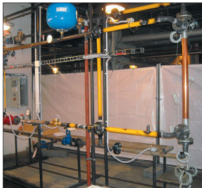
▼ Obr. 2 ● Pohled na sestavenou experimentální měřicí linku, vpravo trubkový výměník
