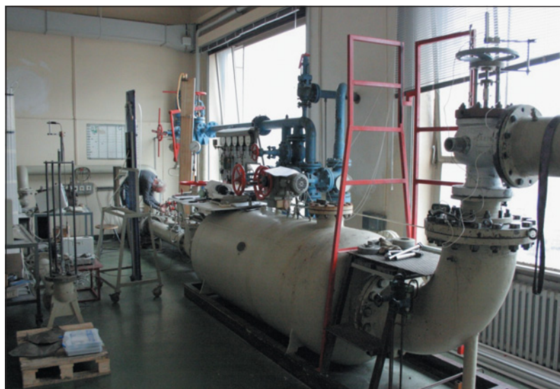
▼ Obr 2 ● Tělo pojistného ventilu v laboratoři Aerodynamického institutu při Technické univerzitě v Aachen, vzduch 0–6 bar abs.
