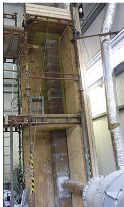
▲ Obr. 6 ● Ukázka zkušební sestavy pro testování bezpečné vzdálenosti hořlavých materiálů od povrchu komínového systému
