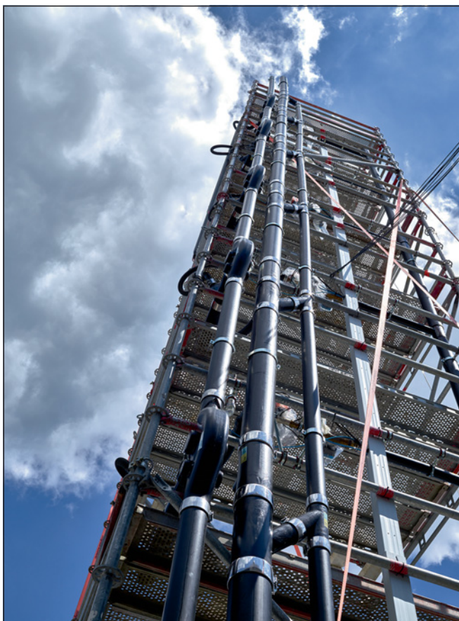
▲ Obr. 2 ● Testování v reálných podmínkách – před uvedením na trh testovali vývojoví inženýři novou technologii SuperTube v centrále Geberit ve švýcarském městě Rapperswil-Jona na 30 metrů vysoké testovací věži
