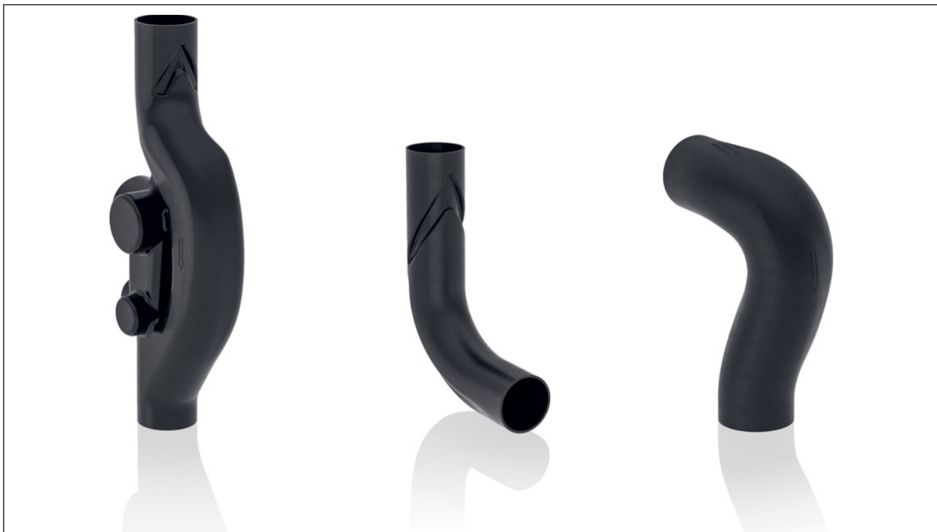
▲ Obr. 1 ● Hydraulicky optimalizované: Základ technologie Geberit SuperTube tvoří osvědčená tvarovka Sovent a dvě nově vyvinutá kolena. Interakce těchto tří prvků umožňuje zachování vzduchového sloupce po celé délce kanalizačního systému
