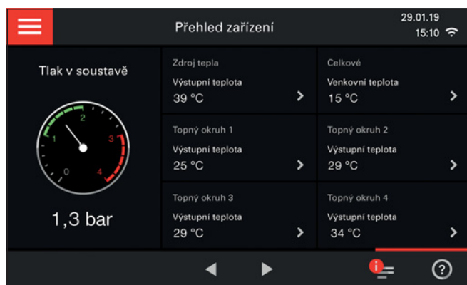
▲ Obr. 1 ● 7palcový barevný dotykový displej nové elektronické platformy Viessmann s digitálním senzorem tlaku
