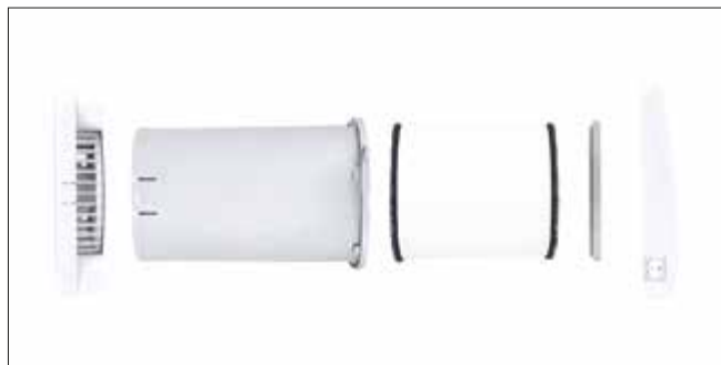
▲ Obr. 8 ● Sestava větrací jednotky – zleva: fasádní mřížka, ochranný tubus s ventilátorem, keramický výměník opatřený na obou stranách filtry G3, vnitřní designový kryt s klapkou
