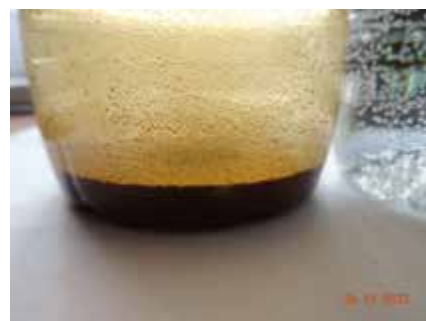
▼ Obr. 8 ● Usazeniny v otopné vodě, napájecí i otopná voda obsahují značné množství volných plynů
