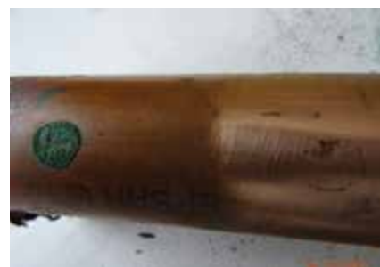
▲ Obr. 4 ● V místech netěsností je materiál porézni
