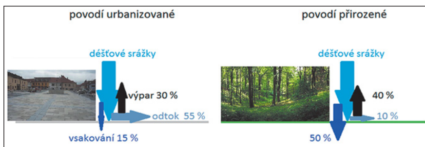
▲ Obr. 9 ● Porovnání odtoku dešťových srážek v urbanizovaném a přirozeném prostředí
