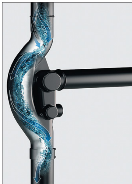
▲ Obr. ● Princip činnosti tvarovky: Vzduchový větrací sloupec se vytváří uvnitř potrubí zásluhou hydraulického řešení tvarovek Geberit Sovent, které odtékající vodu uvádějí do rotace po vnitřním povrchu potrubí
