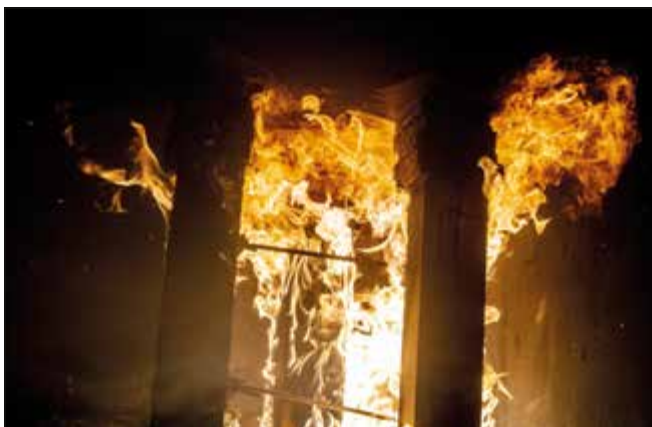
▲ Obr. 3 ● Rozložení experimentu v rámci tzv. Room Corner Testu bylo zvoleno tak, aby 3 sloupky umístěné velmi blízko sebe vzplály okamžitě po zvýšení výkonu hořáku
