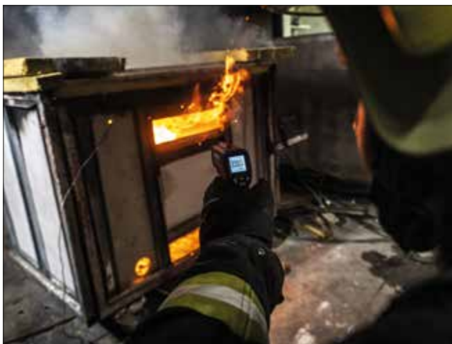
▲ Obr. 1 ● Výzkum vývoje trhlin v dřevěném obkladu pro možnou předpověď jejich velikosti a pravidelnosti pro následné numerické modelování
