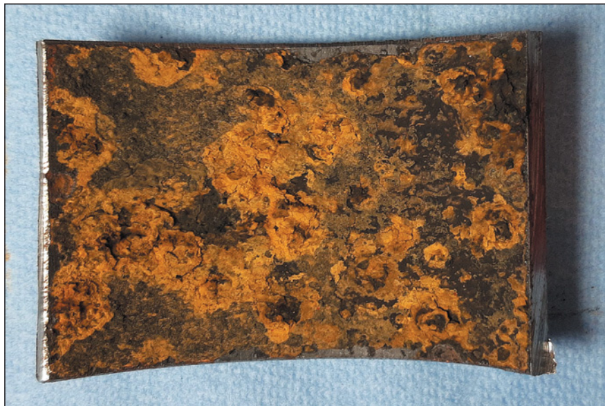
▼ Obr. 3 ● Vnitřní povrch vzorku č. 2 z původního potrubí po aplikaci AQT
