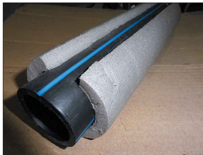
▶ Obr. 7 ● V důsledku malého průměru izolační trubice došlo k jejímu roztržení (Zdroj: autor)
