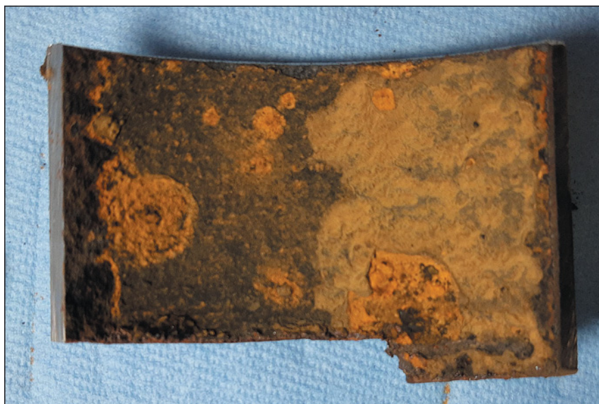
▲ Obr. 2 ● Vnitřní povrch vzorku č. 1 z původního potrubí před aplikací AQT
