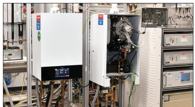
▲ Obr. 2 ● Ve středisku Viessmann Technikum se momentálně testují první prototypy na vhodnost pro 100 % příměsi vodíku
