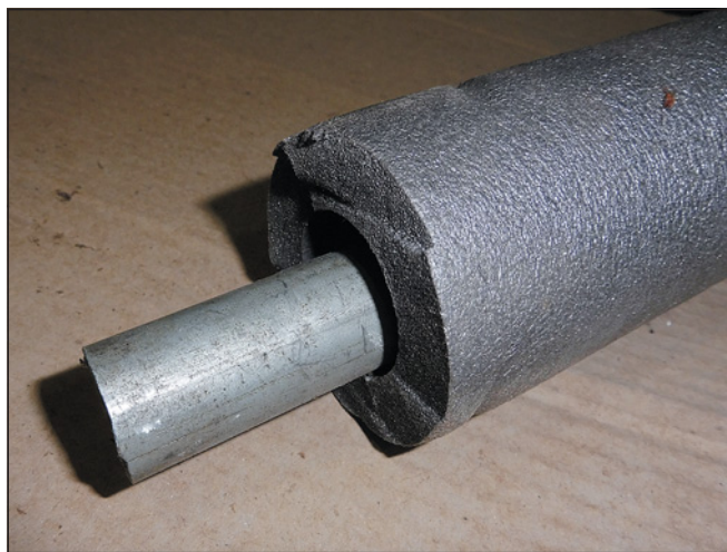
◀ Obr. 8 ● Mezera mezi příliš velkým izolačním pouzdrům a potrubím může mít za následek horší zpracovatelnost při podélném slepení pouzdra (Zdroj: autor)
