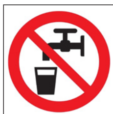
◀ Obr. 9 ● Piktogram pro označení nepitné vody u výtokových armatur
