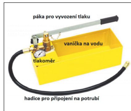
▲ Obr. 14 ● Tlaková pumpa pro zkoušku vnitřního vodovodu
