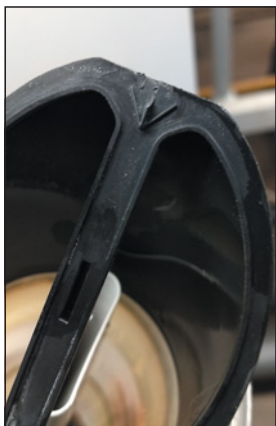
▲ Obr. 5 ● Detail poškození zpětné klapky
