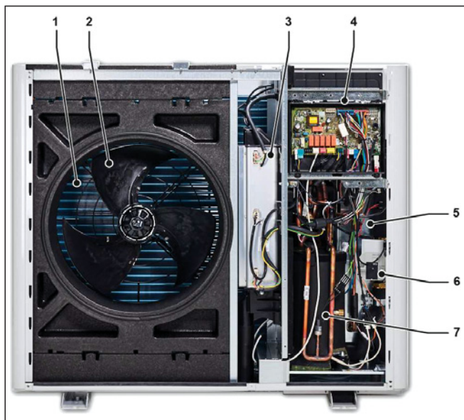
▲ Obr. 2 ● Vnitřní konstrukce tepelného čerpadla, pohled zepředu 1 – výparník, 2 – ventilátor, 3 – měnič, 4 – elektronická jednotka, 5 – kondenzátor, 6 – oběhové čerpadlo, 7 – kompresor
