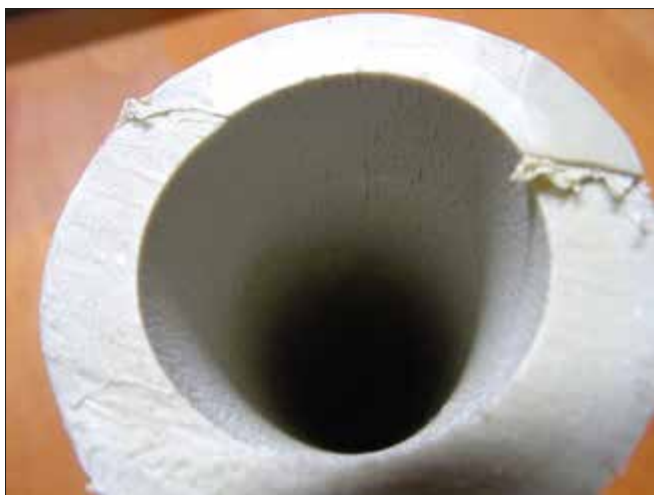
▲ Obr. 1 a 2 ● Narušení vnitřního povrchu potrubí z PP-R působením dlouhodobé expozice oxidu chloričitého (pomerančový povrch)
