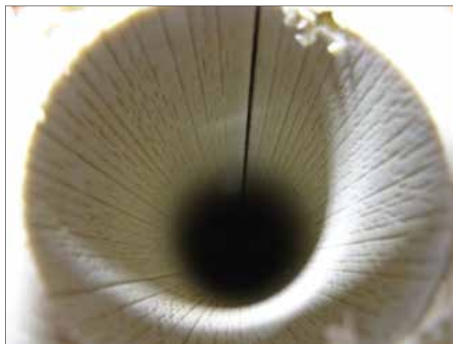
▲ Obr. 1 a 2 ● Narušení vnitřního povrchu potrubí z PP-R působením dlouhodobé expozice oxidu chloričitého (pomerančový povrch)
