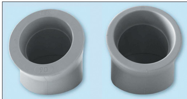
▼ Obr. 2 ● Vyšší odolnost materiálu PP-RCT (vpravo) umožňuje zmenšení tloušťky stěny
