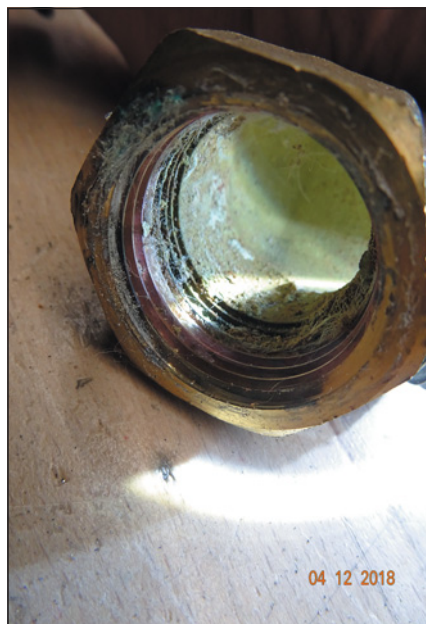
▲ Obr. 2 ● Inkrusty ve vstupním šroubení do výměníku tepla pro přípravu TV
