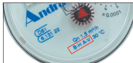
▲ Obr. 7 ● Označení polohy osazení vodoměru do potrubí a třídy přesnosti měření
