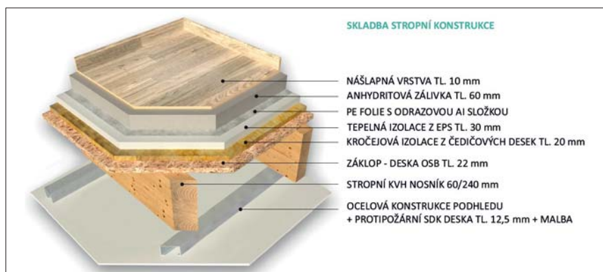
▼ Obr. 3 ● Řez stropní konstrukce s podlahou
