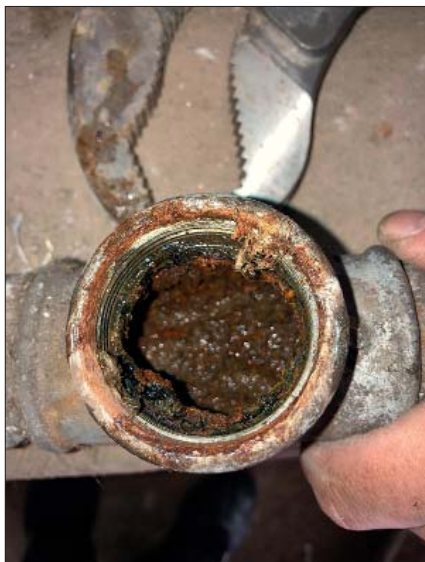
▲ Obr. 11 ● Inkrustace v původních trubkách a tvarovkách
