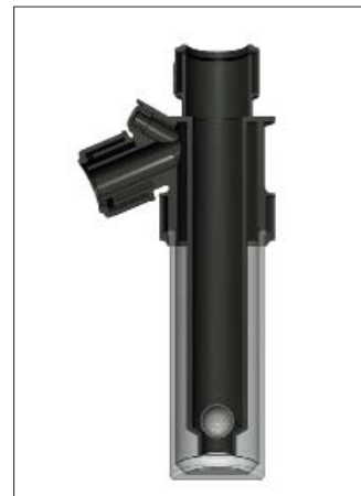
▲ Obr. 2 ● Řez sifonem, dole detail pozice teflonové kuličky v případě provozu bez kapaliny
