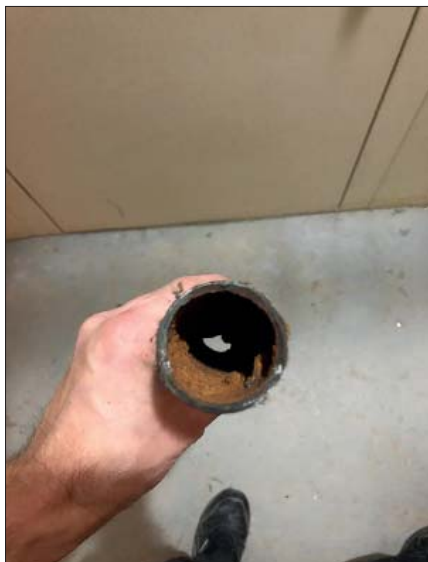
▲ Obr. 10 ● Inkrustace v původních trubkách a tvarovkách
