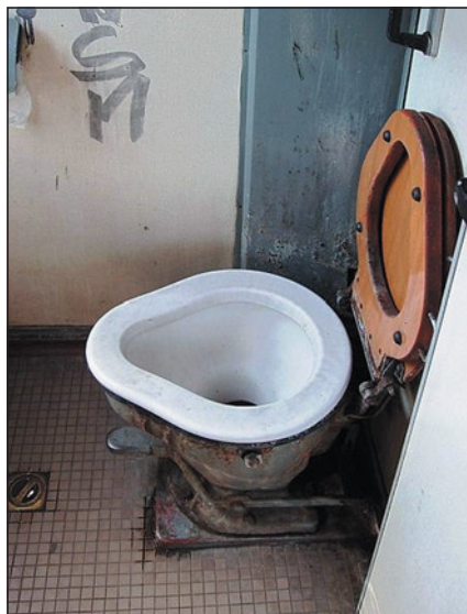
▲ Obr. 3 ● Stará WC mísa typu „Balma“ používaná dříve ve vlacích příměstských i vnitrostátních
