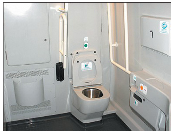
▲ Obr. 5 ● Zařízovací předměty a sklopná/posuvná madla ve vlaku Pendolino
