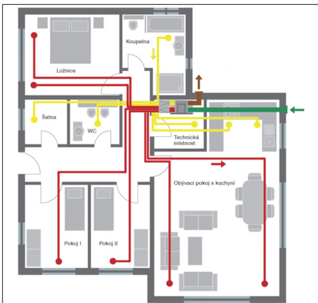
▼ Obr. 2 ● Půdorys s vedením rozvodů vzduchu
