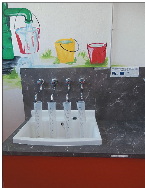
▼ Obr. 3 ● Měření úspory vody odměrnými válci u různých spořičů vody
