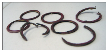
▲ Obr. 2 ● Fibrové těsnění otopné soustavy je rozleptáno teplonosnou kapalinou
