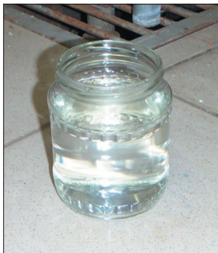
▲ Obr. 3 ● Napájecí voda byla čirá a odplyněná, nevykazovala agresivitu vůči konstrukčním materiálům
