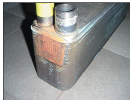
▼ Obr. 2 ● Výměník tepla pro přípravu teplé vody bylo nutné často vyměňovat z důvodů netěsností
