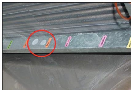
Obr. 11 Ukázka zjištění vlivů vybraných čistících prostředků na korozi vnitřního povrchu jednotky
