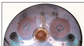
Obr. 3 Různá provedení bourdonových trubec a vahadlového systému
