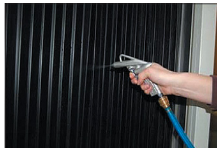
Obr. 11 Ukázka zjištění vlivů vybraných čistících prostředků na korozi vnitřního povrchu jednotky
