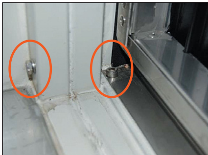
Obr. 10 Problematicky čistitelná místa kolem hlav šroubů
