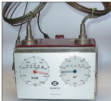
Obr. 8 Různá provedení mechanických měřičů tepla ▲▲▲
