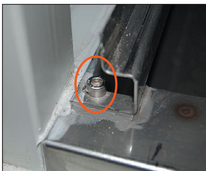
Obr. 11 Ukázka zjištění vlivů vybraných čistících prostředků na korozi vnitřního povrchu jednotky
