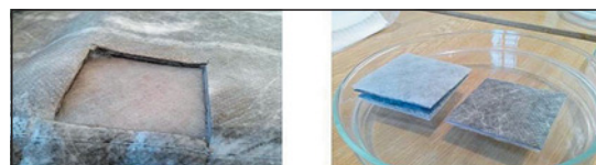
Obr. 3 Odběr vzorků pro kultivaci z filtrační tkaniny třídy filtru F8 (nahore) a třídy filtru G4 (dole)
