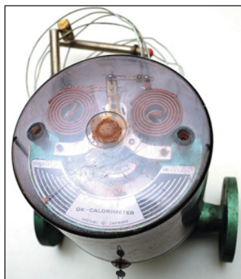
Obr. 8 Různá provedení mechanických měřičů tepla ▲▲▲
