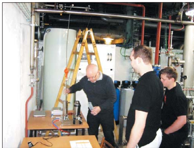
Obr. 5 Měření kvality páry prováděné zástupcem britské společnosti Keith Shuttleworth & Associates Ltd (KS & A Ltd.), panem Timothy Boxem, společně s pracovníky společnosti E S L, a.s.
