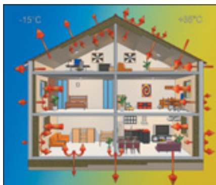
▲ Obr. 1 ● Výpočtem tepelných ztrát se určí teoretická hodnota, jejíž vztah k realitě může být zatížen významnou chybou
