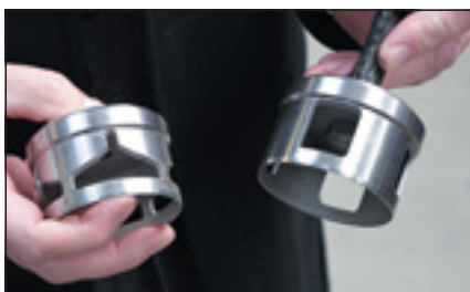
▼ Obr. ● Polotovarem může být nejen těleso ventilu, ale i kuželka, sestavená vrchní část ventilu atp.
