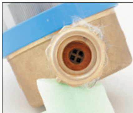
▲ Obr. 13 ● Vstup vodoměru
