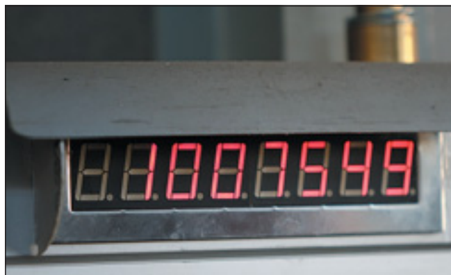
▲ Obr. ● Displej ze zkušebny ukazuje, že počet zkušebních cyklů armatury přesáhl 1 milion cyklů a dále pokračuje
