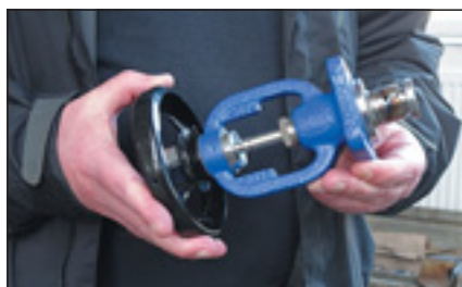
▼ Obr. ● Polotovarem může být nejen těleso ventilu, ale i kuželka, sestavená vrchní část ventilu atp.
