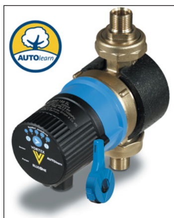
Obr. 2 Špičkovým modelem nové konstrukční řady BlueOne je čerpadlo BWO 155 SL se samoučícím modulem (technologie AUTOlearn). Čerpadlo se učí, kdy obyvatelé domu potřebují teplou vodu, a podle toho přesně zajišťuje cirkulaci
