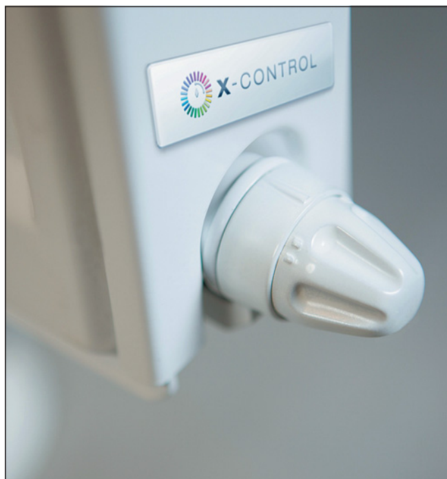
Obr. 7 Rozdělovacím ventilem lze navolit zatékání pouze do čelní desky, částečně i do zadní nebo zvolit běžné paralelní protékání obou desek; volba aretační objímky hlavice ventilu umožňuje jeho přestavení podle toho, která deska bude montáží radiátoru zvolena jako čelní
