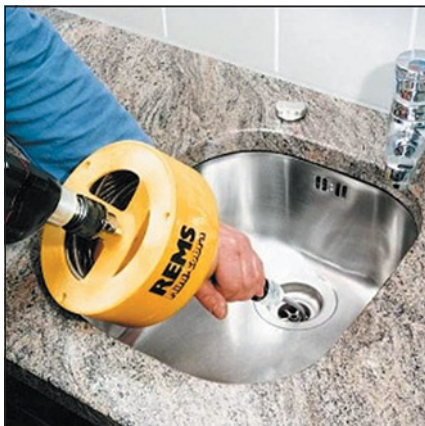
▲ Obr. 5 ● Čištění čistící pružinou s elektromotorem
