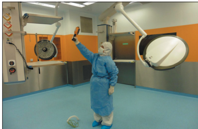
▲ Obr. 4 ● Měření koncentrace prachu na operačním sále, foto: archiv Olgy Rubinové
