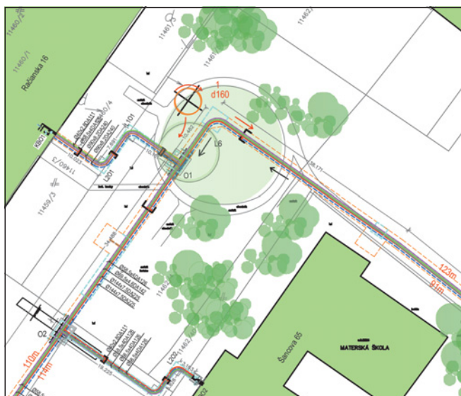
▲ Obr. 2, 3 ● Detail z kladečského plánu při pokládce dimenze d160
