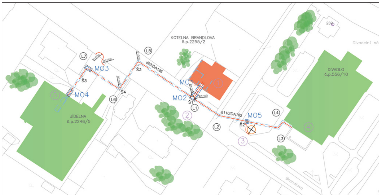
▲ Obr. 5 ● Kladecký plán a vyznačení montážních otvorů při vtahování potrubí do existujícího technického kanálu v Chebu
