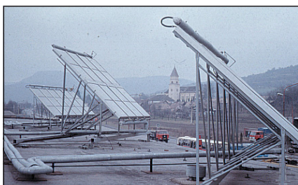
▲ Obr. 14 ● Podniková zkušebna slunečních kolektorů ve Žiaru nad Hronom (SR); porovnávaly se pouze výkony s referenčním vzorem
