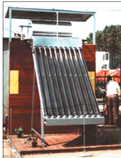
▲ Obr. 21 ● Gravitační ohřev vody pro zemědělská družstva, 10 trubic, 2 m 2 , první cena (Zlatý kosák) na výstavě Agrokomplex Nitra, 1987
