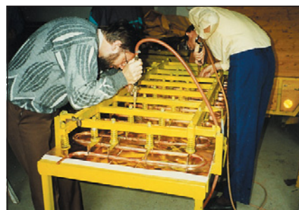
▲ Obr. 10 ● Zařízení pro výrobu absorberů svépomocí – nahoře se ohnula trubka do meandru a po otočení se dole připájala k měděnému plechu
