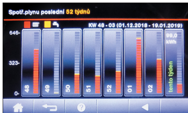
▼ Obr. 6 ● Displej kotle – přehled týdenní spotřeby plynu pro vytápění a přípravu teplé vody
