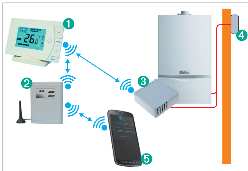
Obr. 1 Prvky a komunikace dálkového ovládání GSM EXEO plynového spotřebiče Vaillant: 1 Regulátor Vaillant – GSM EXEO, 2 GSM komunikátor, 3 Vnitřní komunikační jednotka + modul VR 34, 4 Venkovní čidlo, 5 Mobilní telefon
