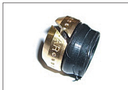
Obr. 2 Demontovaný naříznutý mosazný svěrný kroužek s narušeným pryžovým těsněním
