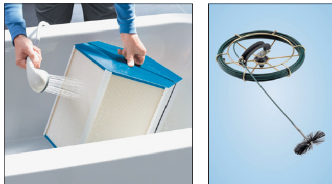
Obr. 7 Entalpické výměníky nové generace od firmy Zehnder s polymerovými membránami, rekuperující teplo i vlhkost, lze osprchovat nebo několikrát ponořit do teplé vody a tím podstatně ještě lépe vyčistit, prodloužit jejich životnost a zabezpečit nesníženou účinnost rekuperace po mnoho let. O čistotu potrubí se postará vysavač s rotujícím kartáčem.
