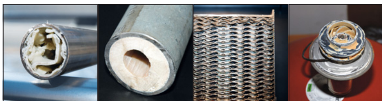
▲ Zleva: nerezová trubka, pozinkovaná trubka, deskový výměník, cirkulační čerpadlo
