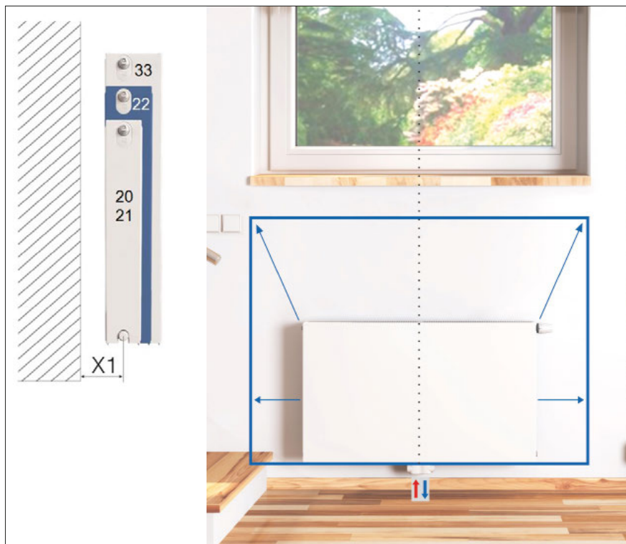
▼ Obr. 4 ● Při výměně lze s využitím těles RADIK VKM8 a spodního středového připojení zaměnit rozměry tělesa bez nutnosti úpravy připojení. Tato potřeba může vzniknout například při přechodu na jiný zdroj tepla, typicky ze zastaralého kotle na pevná či kapalná paliva na nový nízkoteplotní zdroj.
