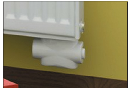
▲ Obr. 5 ● Správné napojení tělesa Radik VK – potrubí je přivedeno podlahou, prochází stěnou za tělesem a vstupuje do šroubení od stěny – těsnicí kroužek není tak namáhán boční silou jako v předchozím případě a nemůže tak dojít k jeho destrukci
