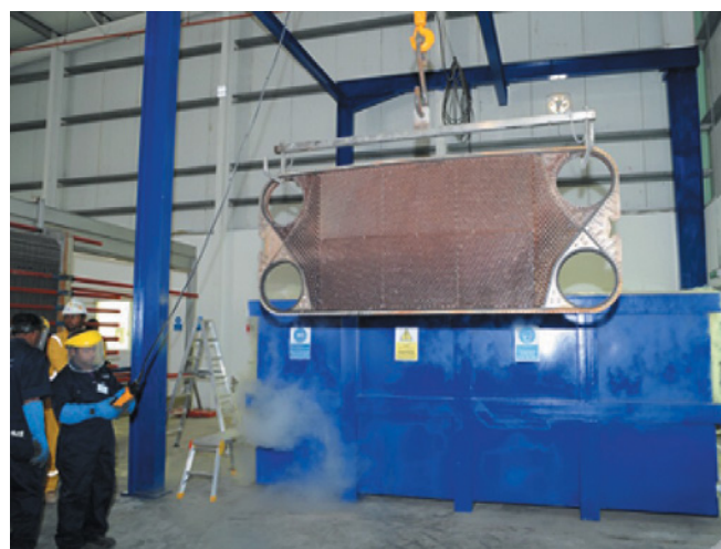
▲ Obr. 4 ● Čištění rozebíratelných výměníků tepla Alfa Laval
