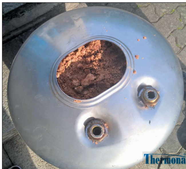
▼ Obr. 5 ● Zásobník TV zcela zanesený vodním kamenem, vyloučeným z „tvrdé“ užitkové vody s vysokým obsahem rozpuštěných minerálních látek
