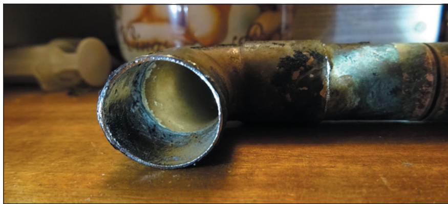
▲ Obr. 4 ● Někteří pájené spoje byly nekvalitně provedeny
