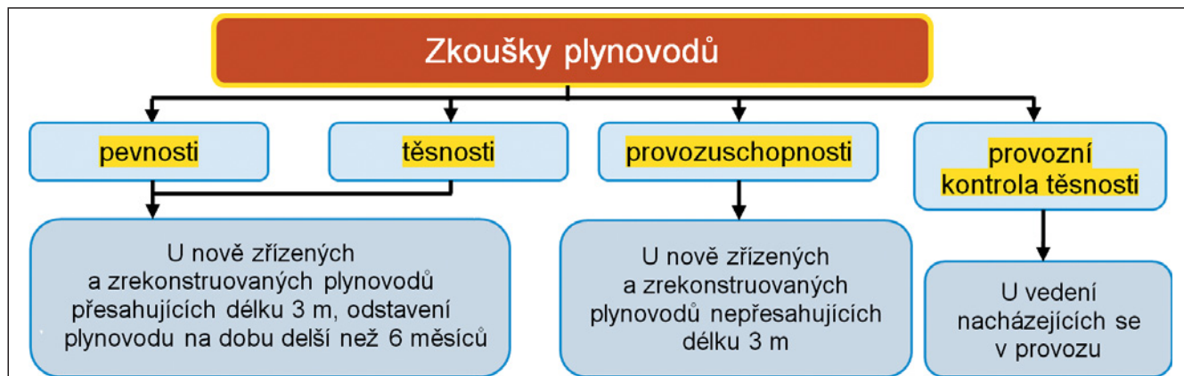
▼ Obr. 23 ● Přehled zkoušek domovního plynovodu podle TPG 704 01
