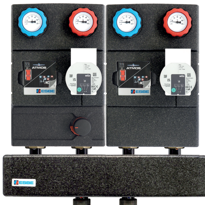
Rozdělovač pro dvě čerpadlové skupiny (dvouokruhový) ATMOS ESBE GMA421 Rozteč 125 mm - 1" ↑↓ 1" (objednací kód: P0515)
