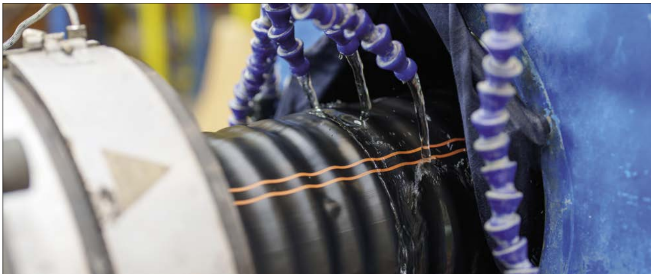
▲ Obr. 5 ● Extrudér vnějšího pláště s chlazením
