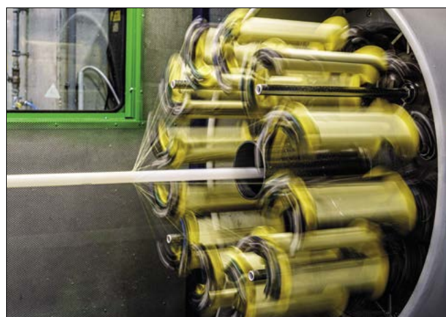
▲ Obr. 2 ● Tkaní aramidovými vlákny okolo hotové PE-Xa trubky
