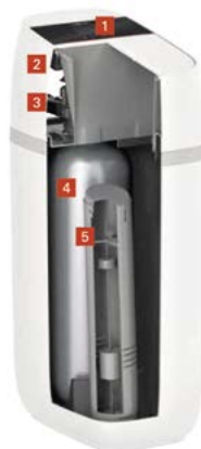
◀ Obr. 3 ● Vitaset Aqua: 1 – Ovládací jednotka s 3,5palcovým dotykovým displejem, 2 – Komunikační modul např. pro aplikaci ViCare, 3 – Rotační ventil, 4 – Zásobník s pryskyřicí, 5 – Ventil solanky s dvojitým zabezpečením
